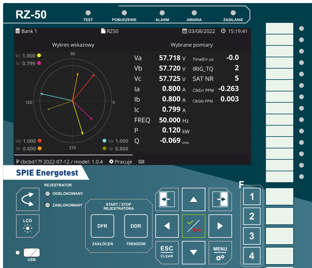
Rysunek 2.3 Widok panelu sterowania (HMI) z przykładową organizacją ekranów.
